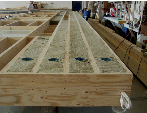
Kuvat 1a ja 1b. Kuvan kerrostalo peruskorjattiin esivalmistetuilla julkisivuelementeillä, joihin oli asennettu ilmanvaihtojärjestelmän korvausilmaputket. Kuvat: Jari Kiuru ja Jukka Sevon.
