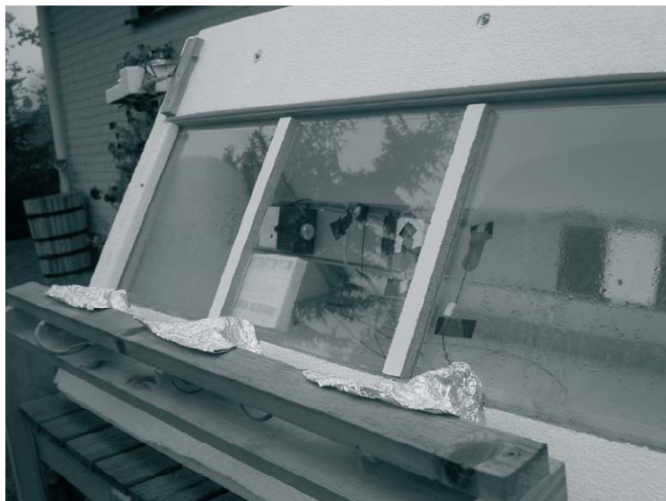
Kuva 5.2 Erilaisilla ulkolasin pinnoilla varustettuja ikkunoita kondensoitumiskokeessa. Vasemmalla itsepuhdistuva ulkolasi, keskellä matalaemissiviteettipintainen ulkolasi ja oikealla tavallinen ulkolasi. (Werner 2007)
