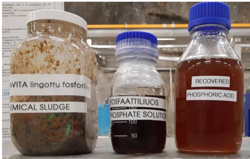
Kuva 20. RAVITA™ prosessissa käytettävä kemiallinen liete, erotettu fosfaattiliuos ja lopputuote, fosforihappo. (Baltic Smart Water Hub 2020)
