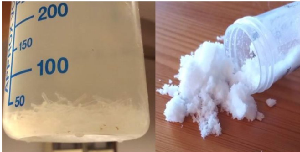
Kuva 14. Ammoniumsulfaattiliuos ja kiteytetty NPHarvest-lopputuote. (Kaljunen 2022)
