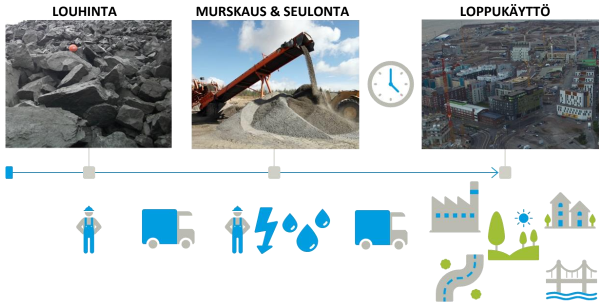
Kuva 3: Louheen yksinkertaistettu elinkaari. Louhinnan jälkeen louhe joko käytetään suoraan tai kuljetetaan murskaamolle jalostamista varten. Murskausaluetta käytetään usein louheen välivarastoalueena ennen kuljettamista lopulliseen käyttökohteeseen.
