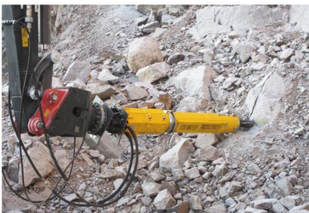
Kuva 7: Kaivinkoneeseen asennettu hydraulinen halkaisusylinteri ja käsikäyttöinen halkaisusylinteri (Kivirock, 2019).
