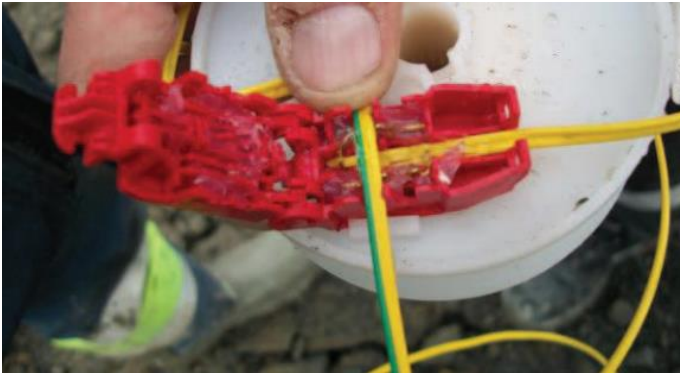
Kuva 15: Elektronisen ”uni tronic 600”-sytytysjärjestelmän johtimien kytkentäkappale. Johto, jossa on pinnalla vihreää, on välijohtinta. (kuva: Lakkala, 2013)
