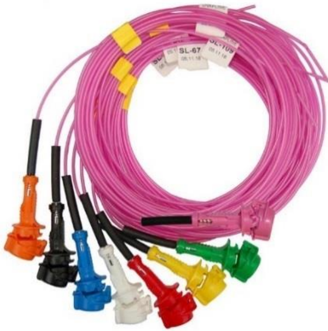
Kuva 10: Impulssisytytysjärjestelmän pintahidasteita. Sytytysimpulssin saavuttua violettia impulssiletkaa pitkin kuvassa näkyvään muoviseen jakopäähän räjähtää sen sisällä oleva hidasteinen nalli, mikä siirtää sytytysimpulssin seuraaville hidasteletkuille. Räjähdyksineeseen kiinnitettävät impulssiletkut ovat muuten vastaavanlaisia, mutta jakopään tilalla on pelkkä hidasteinen nalli, joka räjähtäessään sytyttää varsinaisen räjähdysaineen. (Kuva: Oy ForcIt Ab, 2001).
