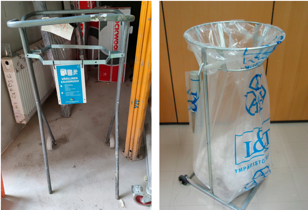
Kuva 4. Muovisäkkejä varten voidaan käyttää muovisäkkitelineitä, joihin säkki on helppo asentaa. Telineeseen on hyvä laittaa opaste siitä, mitä jätettä säkkiin saa laittaa (kuvat Ramboll Finland Oy ja Lassila & Tikanoja Oyj).
