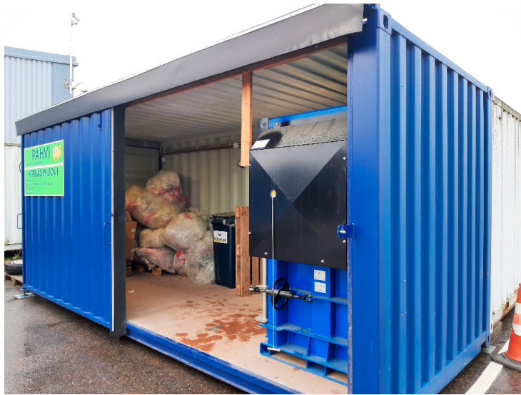
Kuva 6. Jätepaalain voidaan sijoittaa työmaalla esim. konttiin, jonne myös kerätty kalvomuovi ja valmiit paalit voidaan säilöä (kuva Helsingin kaupunki).
