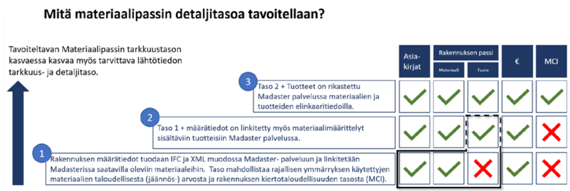
Kuva 10. Madaster palvelun tuottajat esittivät materiaalipassin rajaamista tavoiteltavan tarkkuustason ja käyttötarkoitusten mukaisesti kolmeen eri tasoon. ATT:n hankkeessa pyrittiin pääosin tasoon yksi.
