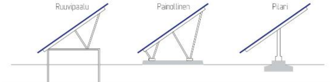
Kuva 3: Erilaisia ratkaisuja aurinkovoimaloiden perustuksia varten. (Ramboll)
