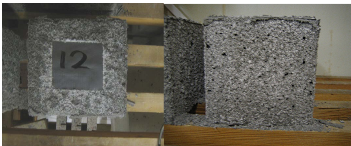
Kuva 33. Alkalihärmeen muodostuminen joidenkin koekappaleiden pinnalle oli voimakasta. Kaikissa koekappaleissa ei härmeen muodostumista havaittu.
