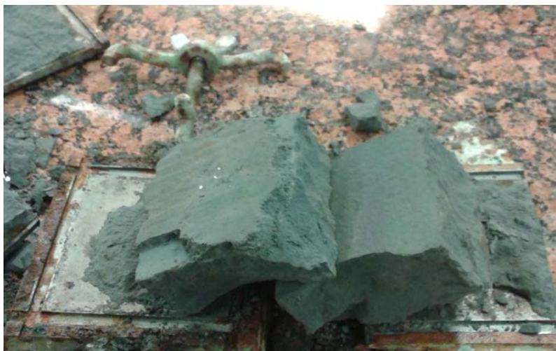
Kuva 27. Jotkut koekappaleet hajosivat tiivistyskerrosten rajapintojen kohdilta muoteista purettaessa.
