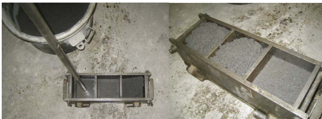
Kuva 17. Koekappalemuottien tiivistäminen RE-menetelmällä.
