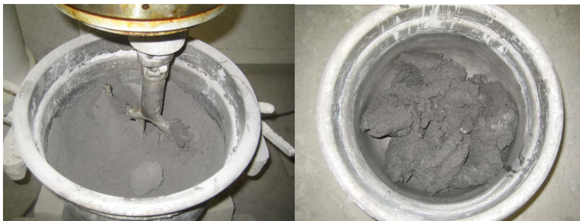
Kuva 26. Vasemmalla optimaalinen vesiansostus RE-massalle. Veden annostus on juuri riittävä pitämään massa kasassa muotoillessa. Oikealla puolella liikaa vettä sisältävä massa, joka muistuttaa jäykkää betonia. Massa muodostaa yhtenäisen massan, jolloin kovettuneen RE-massan lujuusominaisuudet laskevat.
