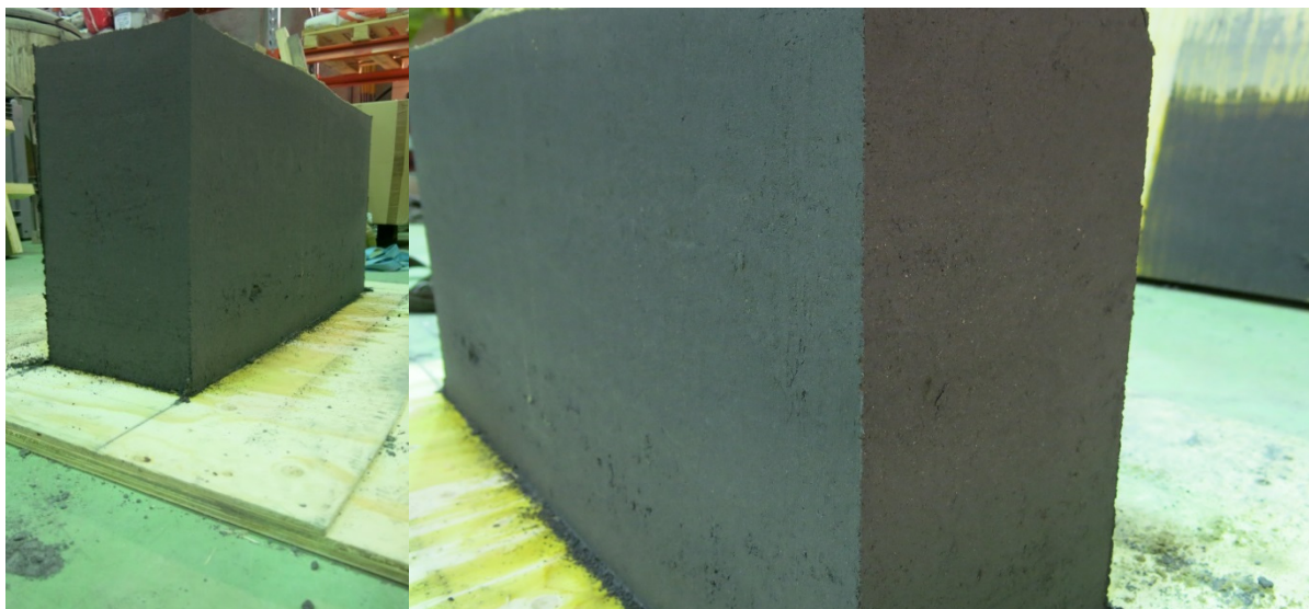
Kuva 39. Kuva valmiista muurirakennedemonstraatiosta 2 välittömästi muotin purkamisen jälkeen.
