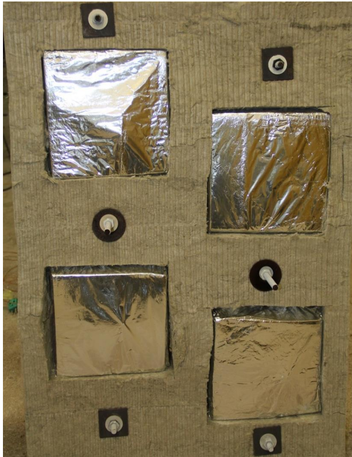
Kuva 8. Koekappaleet kokeen jälkeen kuvattuna uunin puolelta.
