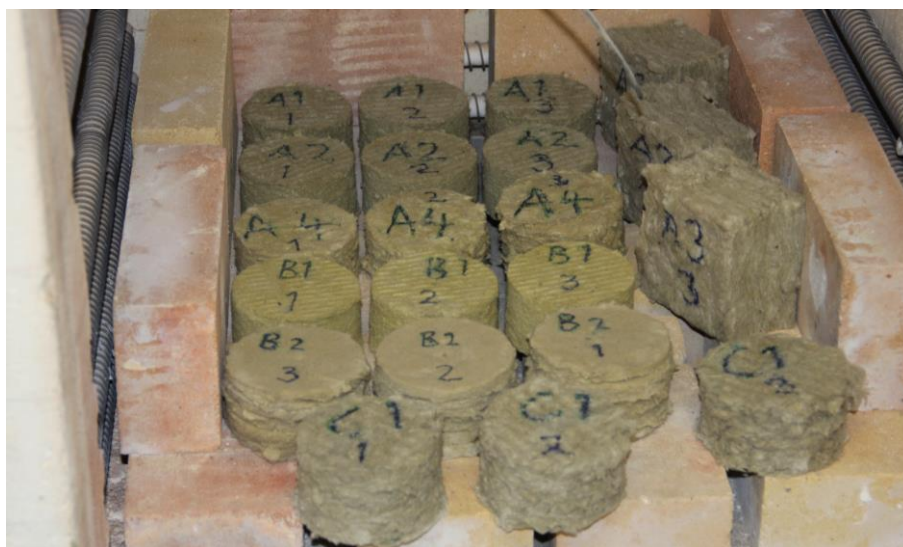
Kuva 3. Koekappaleet asetettuina sähköuuniin orgaanisen aineen määrän määrittystä varten.
