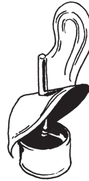
Kääntyvä tuuliohjain ohjaa poistoilmavirran tuulen alapuolelle.
