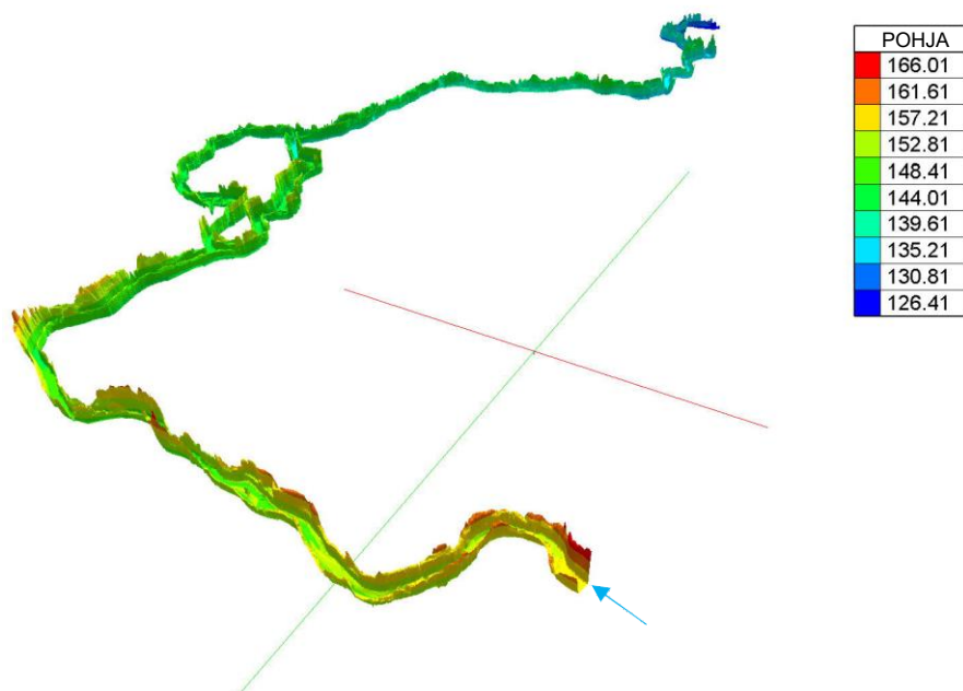
Kuva 4. Maastomalli joen pohjasta ja lähiympäristöstä. Värit kuvaavat korkeutta merenpinnasta RH 2000: ssa. Virtaaman suunta (ks. sininen virtaamanuoli) oikeasta alakulmasta (punakeltaiset sävyt) oikeaan yläkulmaan (sinivihreät sävyt).
